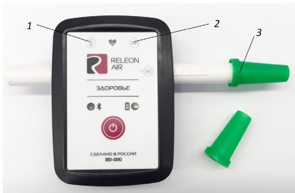
Рис. 3. Мультидатчик по физиологии: 1 — температура тела, 2 — пульс, 3 — частота дыхания (надевает съёмный мундштук)
