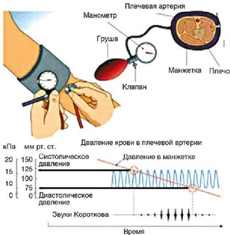
Рис. 2. Измерение артериального давления методом Н. С. Короткова
